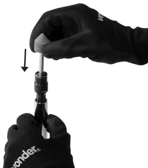
Figura 3 – Instalando uma ponta montada
