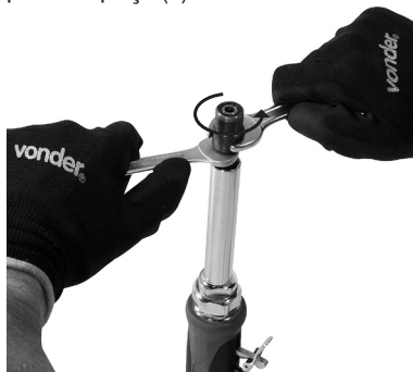
Figura 2 – Retirando a porca da pinça
