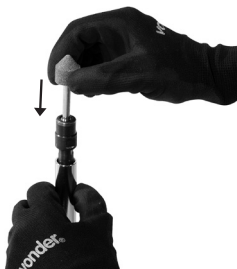
Figura 3 – Instalando una punta montada.
